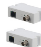
LR1002-1ET/1EC 同軸エクステンダー上のシングルポート長距離イーサネット
